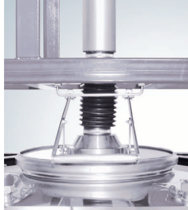
Rührstation im angekuppelten Zustand.
